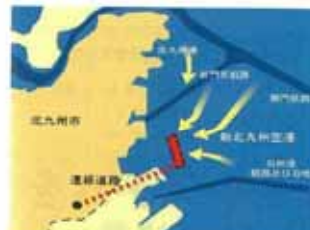
▲港湾事業と連携し、埋込材には浚渫土砂を用いた
